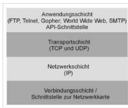
Abb. 6: Protokollstapel bzw. Schichten des TCP/IP nach Matytschak 1994:94
